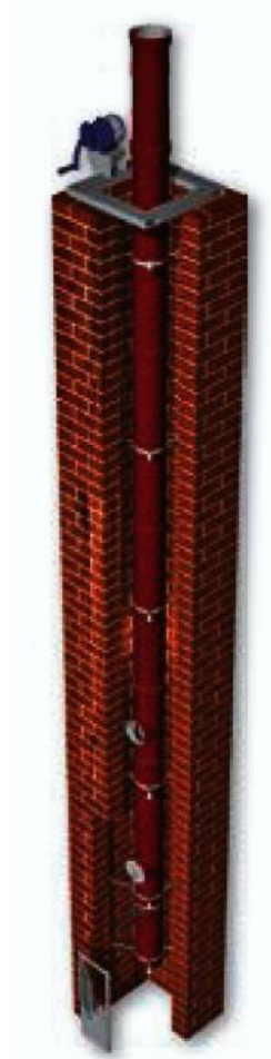
Abbildung 3: Neues Abgasrohr in einem alten Kamin (Quelle: tona)
